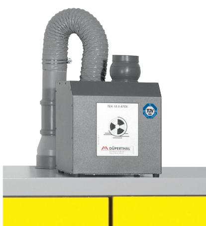
Предназначена для упрощения вентиляции шкафов для безопасного хранения. Вентиляционная установка, включая интегрированный вентилятор, поставляется предварительно собранной и устанавливается непосредственно на шкаф. Корпус изготовлен из листовой стали с порошковым покрытием перламутровой серебрянкой.
